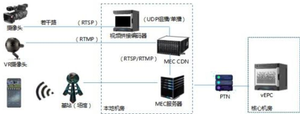
对于视频点播业务，通过 MEC CDN 下沉靠近用户，可以节省骨干和汇聚网络流量，同时可以降低视频业务传输时延，提升视频点播业务用户体验。MEC CDN 下沉方案组网如图 3.4 所示，运营商或 OTT 厂商的 CDN 分发系统根据业务需要，将 CDN 边缘节点进一步下沉到移动网络内部或者接入机房，无线用户通过 MEC 分流模块分流，固网用户通过 OLT 的分流模块进行分流，结合 CDN 的调度机制把来自 MEC CDN 覆盖范围内的用户的视频流量就近引入到边缘 CDN 节点，提高业务访问速度。
